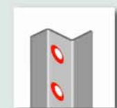
Perçage/fraisage de l' huisserie
